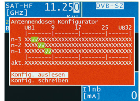
Konfigurationsmenü für programmierbare UNICABLE-/JESS-Antennendosen.
