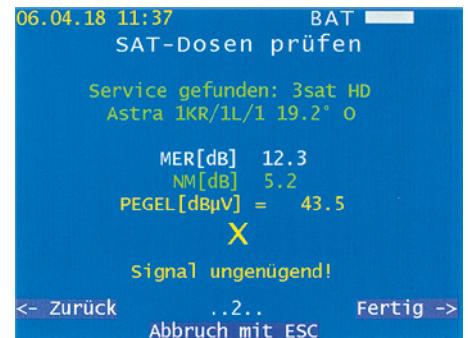
Eines der Assistenzsysteme: einfacher und geführter Check der Signalqualität an der Antennendose.
