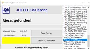
Mit dem Programmier JAP 100 und der Software CSSKonfig muss der JRS an **jedem** Ausgang mit dem File: WB\_all\_10410MHz.dsq auf die Breitbandzuführung umprogrammiert werden.
