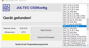
Um mit dem JRS die Sat-Positionen C / D empfangen zu können, muss dieser mit dem Programmier JAP 100, der Software CSSKonfig und dem File: SAT\_C\_D\_A\_B.dsq an **jedem** Ausgang programmiert werden.
