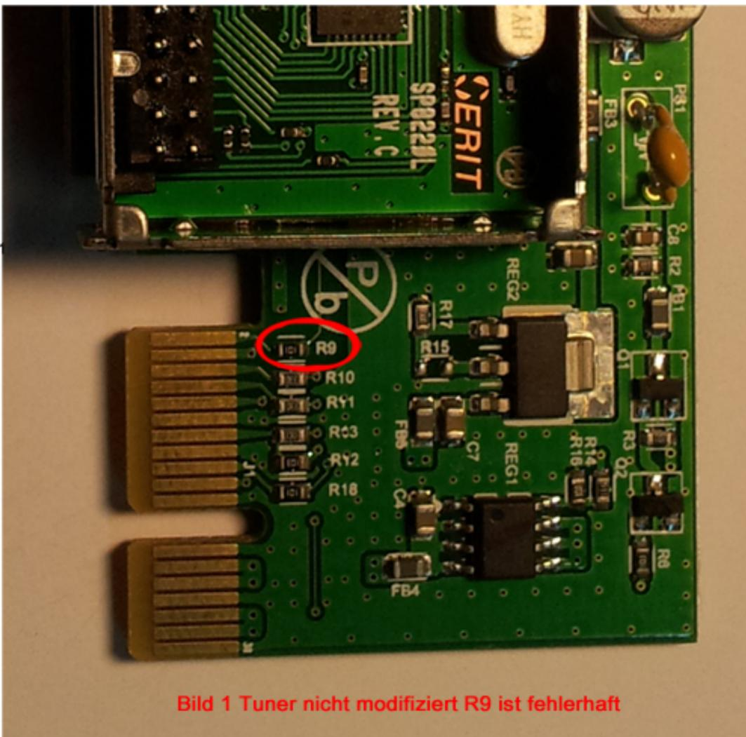
Bild 1 Tuner nicht modifiziert R9 ist fehlerhaft
