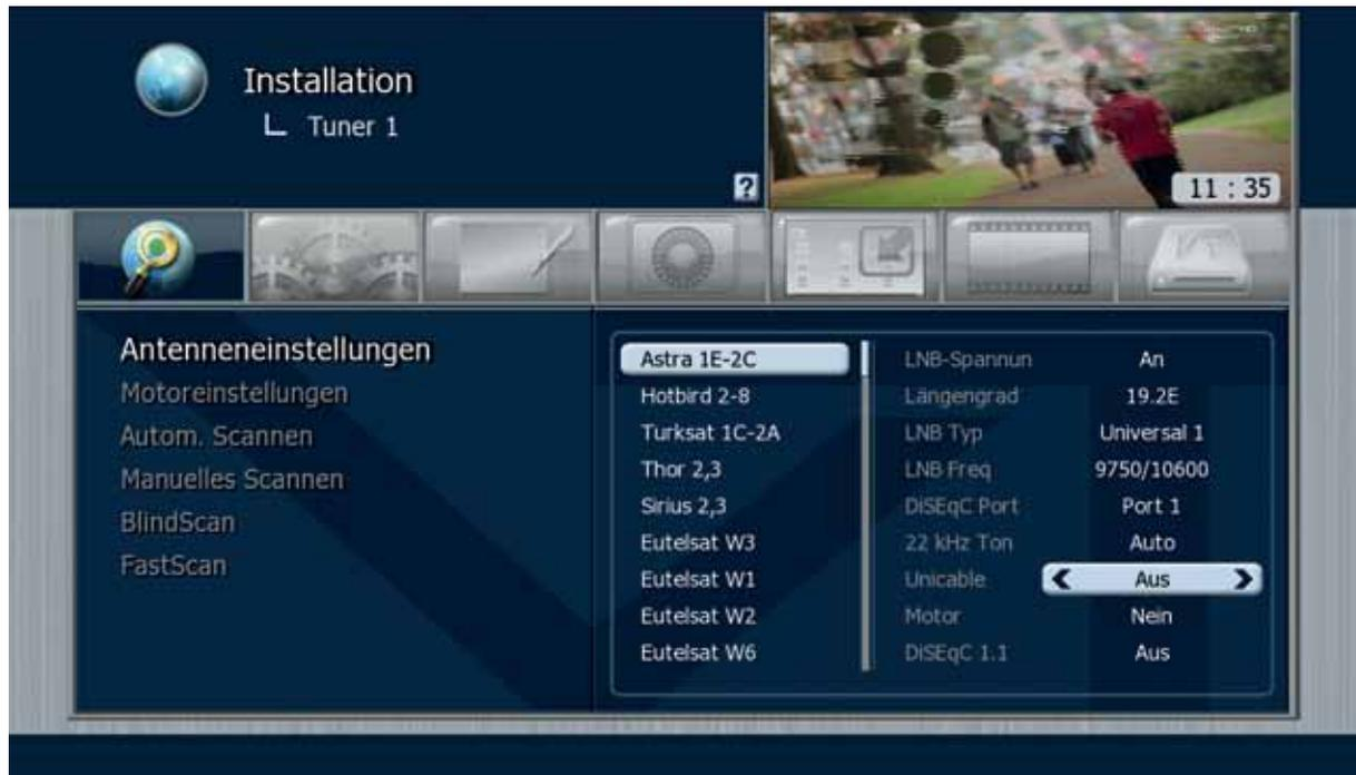
Gehen Sie im Menü unter dem entsprechenden Tuner auf Antenneneinstellungen. Wählen Sie nun den Satellit den Sie empfangen möchten. Setzen Sie den Cursor im rechten Feld auf den Punkt Unicable ( siehe Abbildung links ) und drücken Sie die OK Taste. Es erscheint ein neues Fenster. Weiter mit Schritt 2
